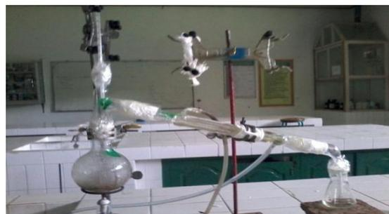
Gambar 1. Seperangkat Alat Destilasi Alkohol
